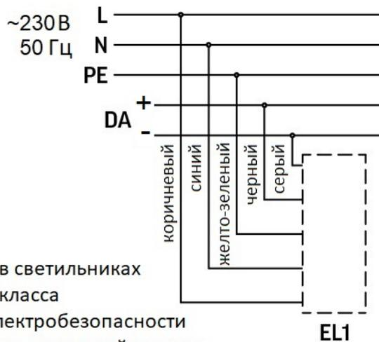
\* в светильниках II класса электробезопасности желто-зеленый провод отсутствует.
