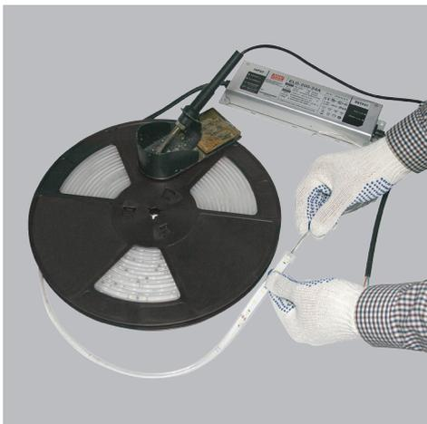
5. Плотно прижать силиконовую крышку к концу отрезка
