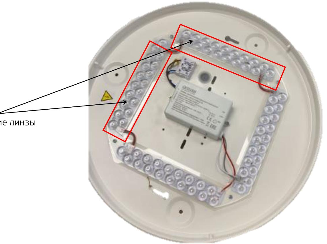
В светильниках Gauss Smart Light установлены оптические линзы, которые:
