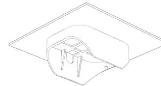
закрыть крышку монтажной коробки;
