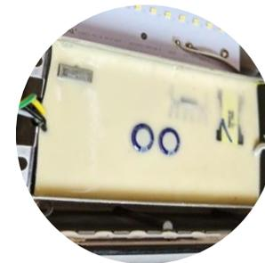
**Импульсный драйвер внутри залит компаундом** – в случае тряски или падения компоненты остаются на своем месте
