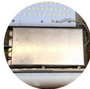
**Отдельный импульсный драйвер (100-240 V)** в металлическом корпусе
