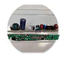
Фиксация драйвера внутри Надежный двухкаскадный драйвер реализован по импульсной схеме, все резисторы вынесены на обратную сторону. Высокое качество
