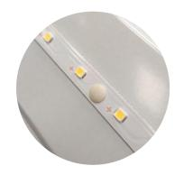
Прижимная клипса гарпун с плоской головкой удерживает толстую текстолитовую подложку, обеспечивая равномерное охлаждение светодиодов
